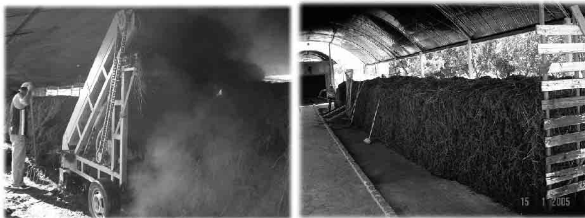
Figura 2: A la izquierda, foto de una maquina utilizada para voltear el compost (semi-mecanizada, pues todavía necesita mano de obra); a la derecha, cordón de compost (“caixote”) formado durante la fase I del proceso de producción.
