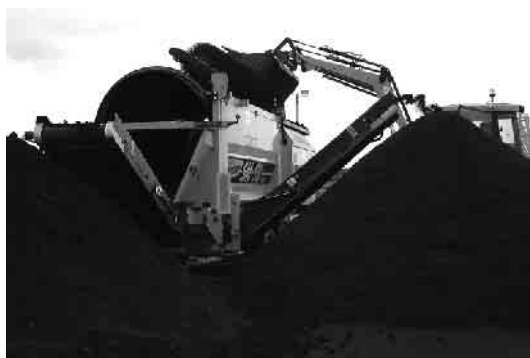
Foto 4. Finalizado el compostaje el producto se criba para retirar tamaños impropios.
