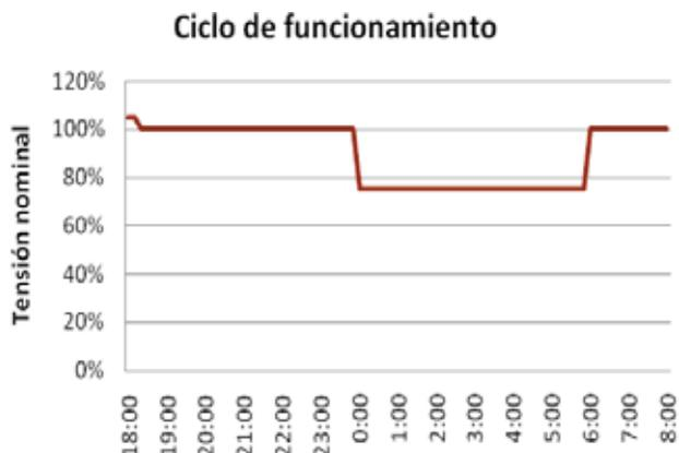
Figura 15: Ciclo funcionamiento reductor estabilizador
