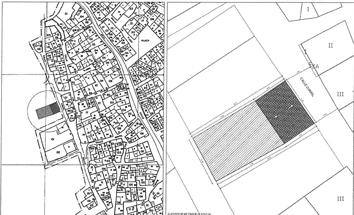
Se trata de una obra de nueva planta consistente en una Vivienda Unifamiliar de dos plantas, con uso de Garaje en planta semisótano y planta baja con uso de Vivienda.
