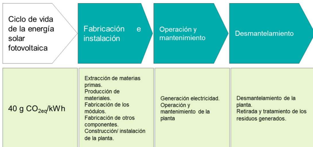
Ilustración 1: Estimación de la huella de carbono de la energía solar fotovoltaica
