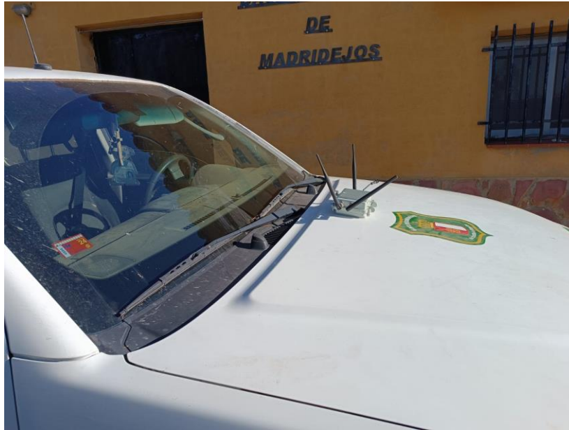
Foto 11 Detalle de la antena receptora, fijada con velcro al capó de uno de los coches de los agentes medioambientales.
